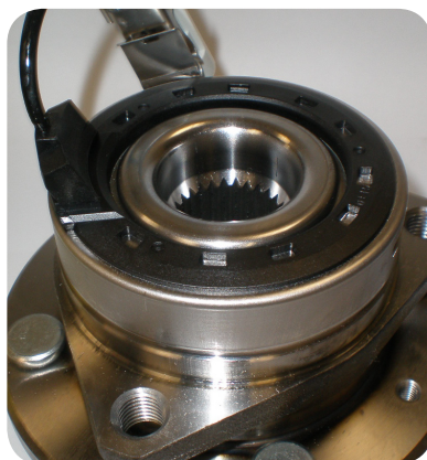
Konstrukcija tipa 2 NE ODGOVARA VKBA 3937
