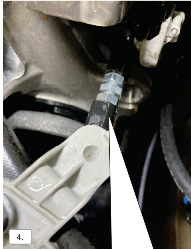
Eibach Regelstangen auf die Länge der Serien-Regelstangen einstellen, montieren und mit den serienmäßigen Muttern verschrauben.
