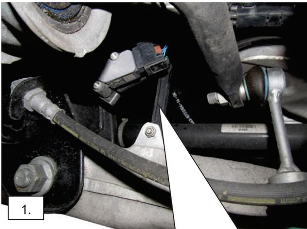
Serien Regelstangen der Höhenstandsensoren lösen und Regelstange entnehmen.
