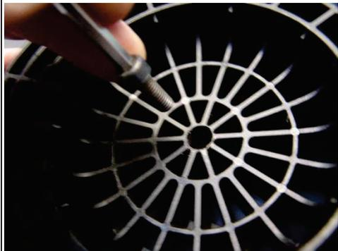
*Verschrauben der serienmäßigen Endanschlätze mit den neuen Endanschlagadaptern mittels mitgelieferter Innensechskantschraube (M6x16mm) an einem Punkt (mittige Bohrung).*
