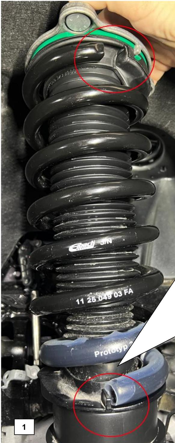
Die serienmäßigen Federaufnahmen unten, an Vorder- und Hinterachse müssen ggf. (in Abhängigkeit von der Federwindungszahl) so positioniert bzw. gedreht werden, sodass die Teller einer Anschlagfunktion nachkommen und ein Verdrehen der Feder ausgeschlossen werden kann (ein Spiel von ca. 5mm zwischen dem jeweiligen Federende und den Anschlägen der Federaufnahmen sind zulässig).
