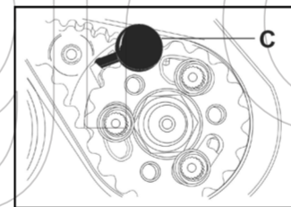
Figura 3: Montar la plantilla C de la bomba de alta presión.
