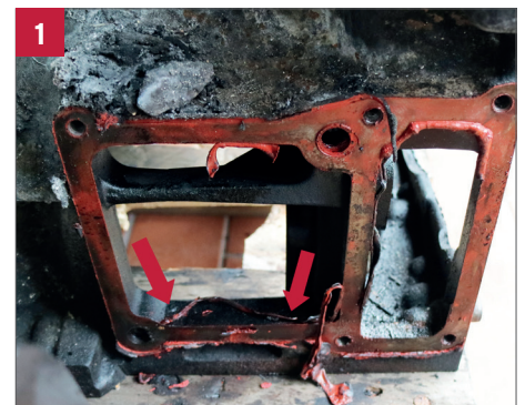
Massive Dichtungsreste am Motorblock gelangten ins Öl
