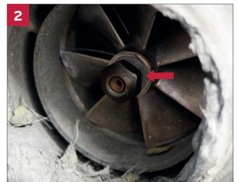
Wellenmutter durch Schmierungsmangel locker gedreht
