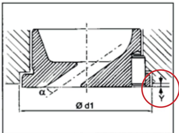
Distancia máxima para el mecanizado del alojamiento de la precámara.
