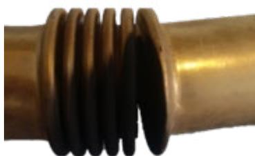
En esta imagen se puede observar una **fisura en el tubo EGT**. La rotura de estos tubos puede producirse por desgaste, corrosión o daños físicos.
