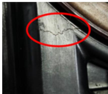
Retén agrietado durante su montaje al no utilizar el útil especial.
