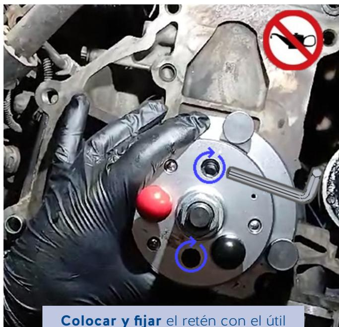
**Colocar y fijar** el retén con el útil en su posición, utilizando el pasador correspondiente.
