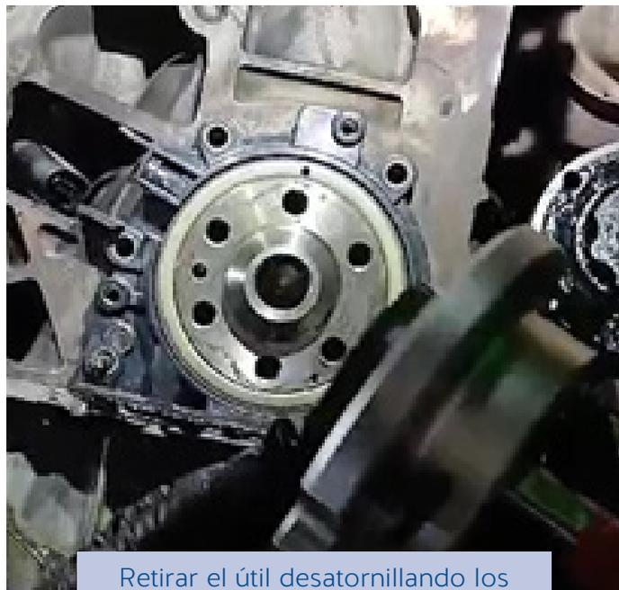
Retirar el útil desatornillando los tornillos de fijación.
