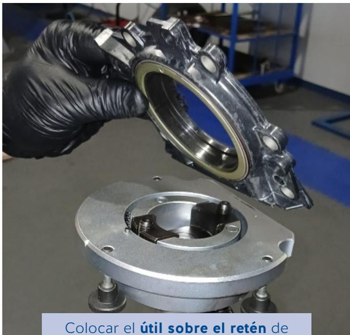
Colocar el **útil sobre el retén** de forma que encaje perfectamente.
