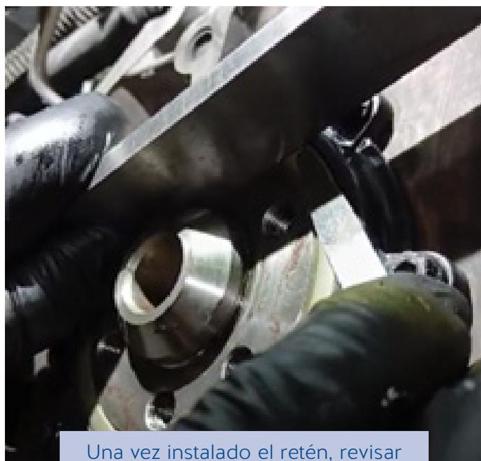
Una vez instalado el retén, revisar la **alineación de la rueda** de impulsos y comprobar que no haya deformaciones.
