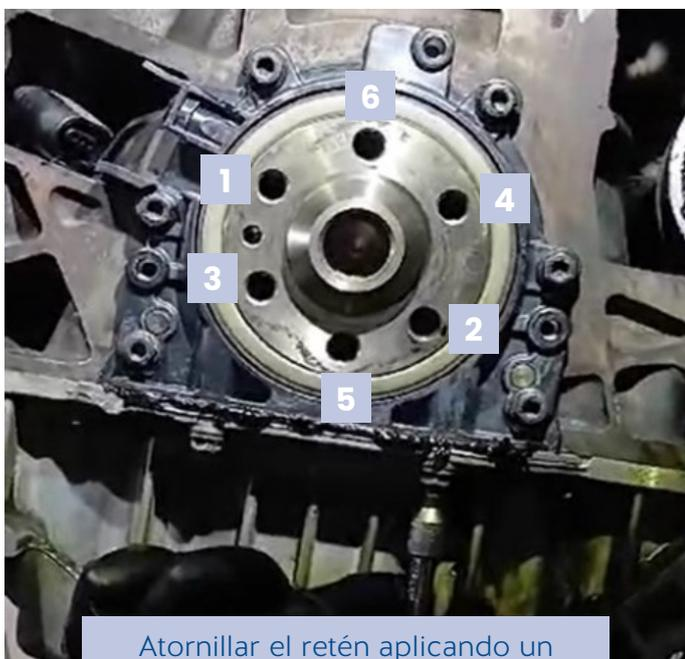
Atornillar el retén aplicando un **apriete de 15 Nm** y siguiendo la secuencia que se indica en la imagen.
