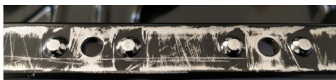
Detalle de los **limitadores de presión** en un cárter usado
