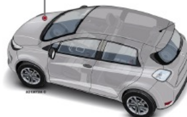
Figura 3. Caja de fusibles.
