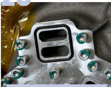
**Junta de refrigeración interna del motor**
