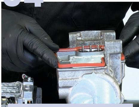
**Montaje junta del inversor**
