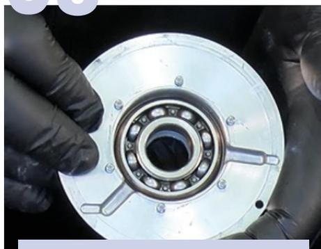
**Montaje del rodamiento del rotor**
