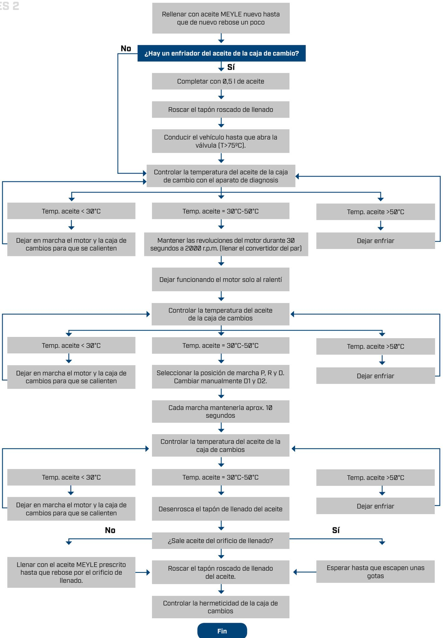
**Atención:** En diversos tipos de cajas de cambio puede estar montada una válvula de bypass, la cual abre o cierra el circuito de aceite al enfriador de aceite. Por ello, con una prueba de marcha suficiente la temperatura del aceite de la caja de cambios deberá alcanzar mín. 75°C. Después de la prueba de marcha dejar enfriar la caja de cambios y controlar de nuevo o corregir el nivel del aceite.
