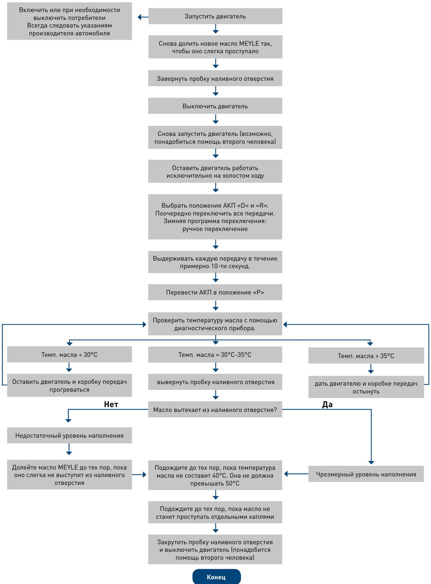
**Внимание:** в зависимости от типа коробки передач в системе может присутствовать перепускной клапан, который пропускает или перекрывает циркуляцию масла к масляному радиатору. По этой причине при проведении пробной поездки температура трансмиссионного масла должна достигнуть, как минимум, 75 °С. По завершении пробной поездки дать коробке передач остынуть и снова проверить уровень масла и при необходимости долить его.
