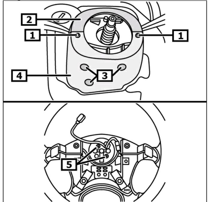
1 Tornillo/s para el revestimiento      2 Revestimiento de la columna de la columna de la dirección arriba arriba
