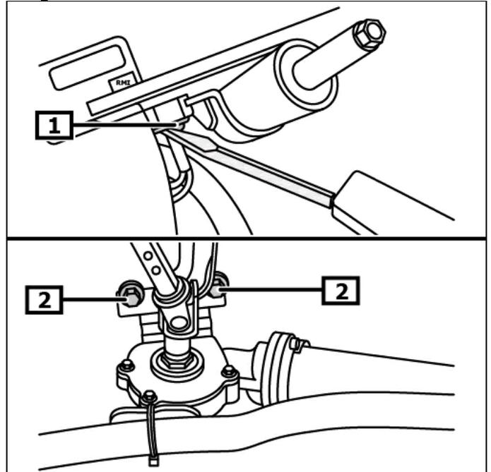
**1** Tornillo/s de ruptura para la columna de dirección      **2** Tornillo/s del soporte en la pared frontal
