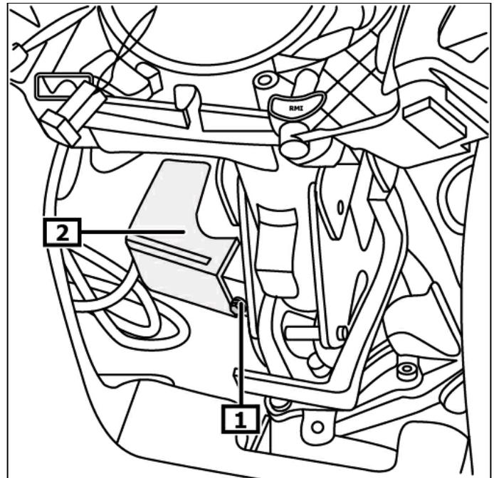
1 La (les) vis du calculateur pour le verrouillage électronique de la colonne de direction
