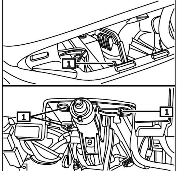
**1** L' (les) écrou(s) de la colonne de direction
