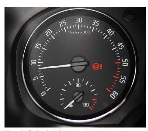
Fig. 1: Spia del sistema sterzante
