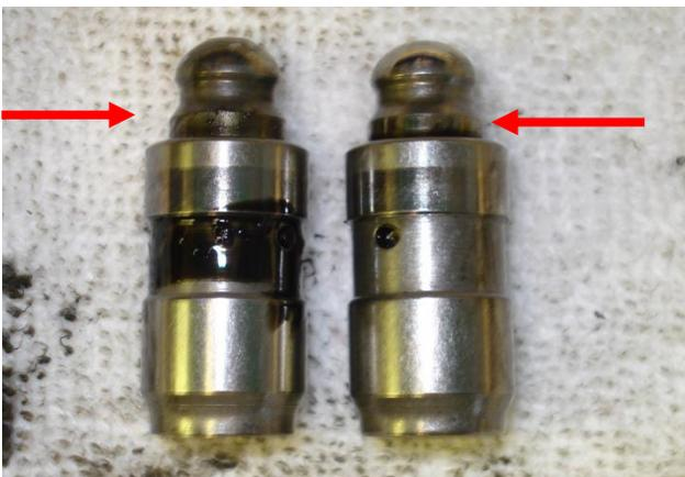
Image 3 : Poussoir hydraulique gauche sorti au maximum ; les soupapes **aspirez !** ne sont pas étanches
