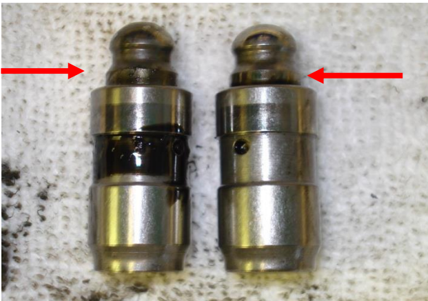
Imaginea 3: tacheți hidraulici coborâți la maxim, supapele nu etanșează – înlocuiți tacheții
