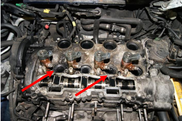
Imaginea 1: răspândirea gazului în galeria de admisie – reetanșeziți-o
