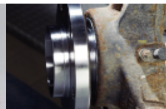
Foto3: 400 6199 10 – pierścień osadcy musi dokładnie leżeć w odpowiednim zagłębieniu zwrotnicy
