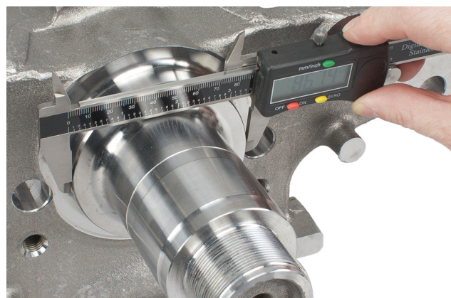
Billede 2: For at afgøre hvilken af de tre beskyttelsesringe, der skal monteres, skal styrespindlens bund måles.
