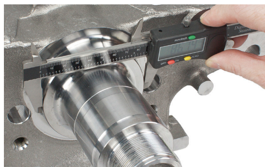
תמונה 2: בכדי לזהות איזה מבין שלושת טבעות המגן מתאימה, חובה לבצע מדידה של קוטר תושבת טבעת האטימה
