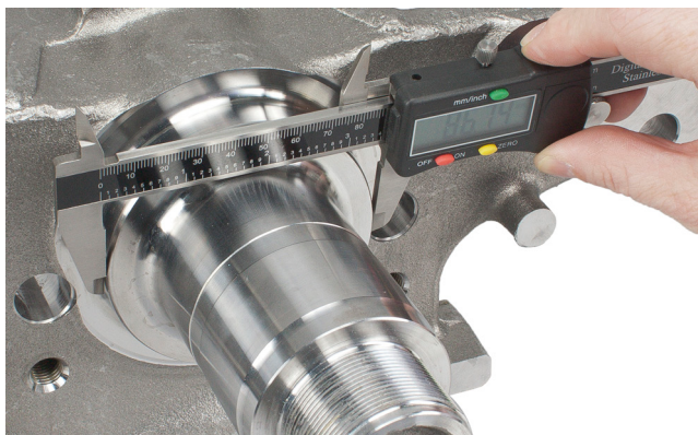
2. ábra: Annak megállapítására, hogy a három védőgyűrű melyike illeszkedik, meg kell mérni a tömítés felfekvő felületének az átmérőjét
