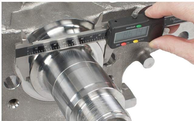
Зображення 2: Щоб визначити, яка з трьох версій захисного кільця підходить, необхідно виміряти діаметр посадочного місця кільця
