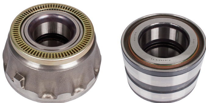
תמונה מס' 1: THU (truck hub unit) and TAM (trans axle module)
