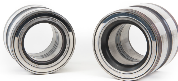
Foto 1: Moduł piasty z uszczelką (po lewej) lub z wyobleniem krawędzi (po prawej)
