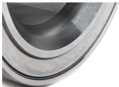
Slika 3: Jedinica glavčine kamiona sa iskošenom ivicom
