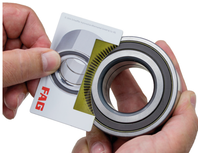
Foto 1: Karta detekcyjna służy do wykrycia strony montażu enkodera aktywnego. Nie zadziała w przypadku enkodera pasywnego.
