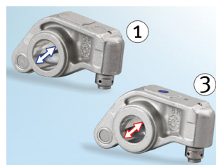
Bild 2: Sugsidans vipparm (1) har större diameter
