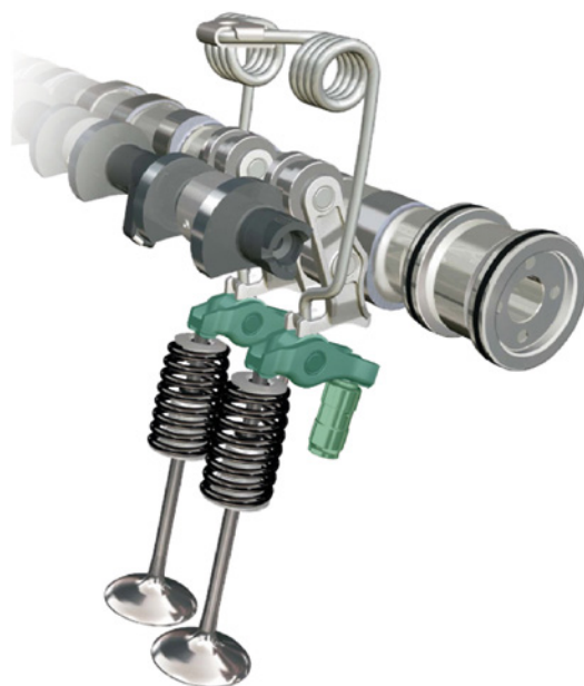
Imagen 1: Vista general del sistema Valvetronic de BMW
