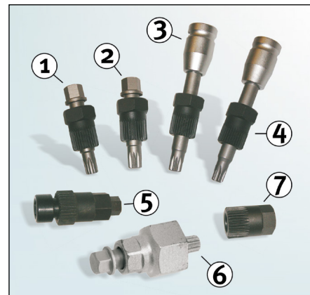
Slika 5: potrebno specialno orodje za demontažo in vgradnjo različnih jermenov za prosti tek
