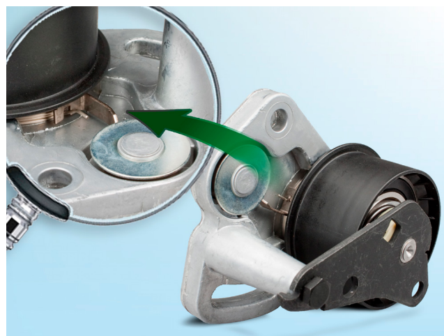
Зображення 1: 531 0629 30 - Натяжний ролик з біметалевою пружиною
