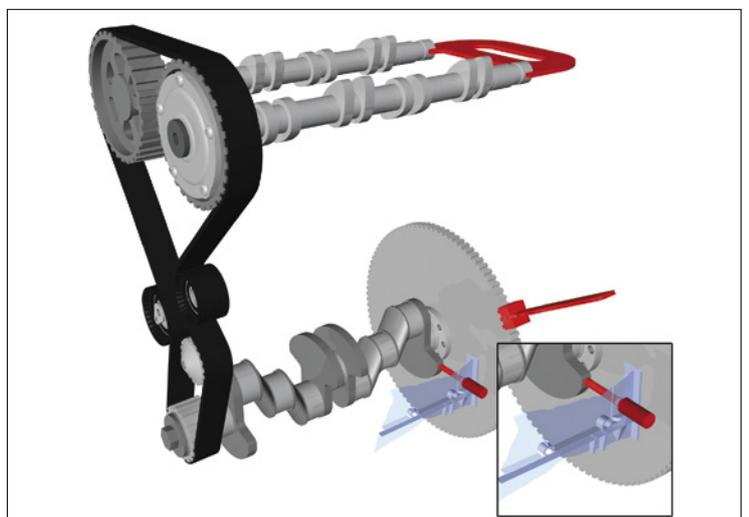
Figura 1: Transmisión de la correa de distribución con herramientas colocadas: placa de ajuste de los árboles de levas (roja), perno de comprobación (roja) del cigüeñal y herramienta de bloqueo (roja) para el volante motor.
