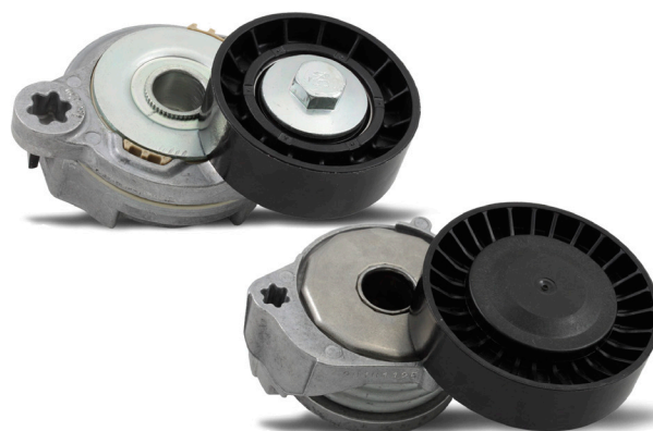
Obrázek 1: Vpravo je zobrazeno provedení Schaeffler Automotive Aftermarket, vlevo přídatná varianta konkurence
