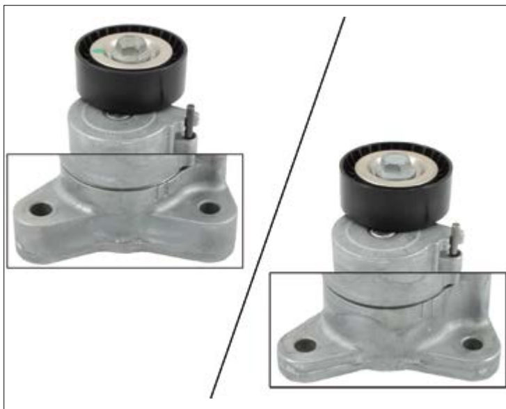
Foto 3: Po lewej, poprzednia wersja z dłuższymi otworami mocowania. Po prawej, nowa wersja ze skróconymi otworami mocowania.
