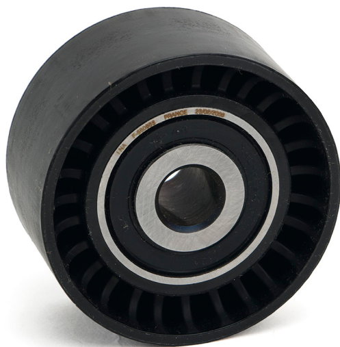
Figura 1: Versiunea veche cu suprafață de rulare din plastic
