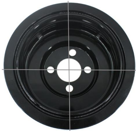
Imagen 1: Disposición asimétrica de los orificios de fijación
