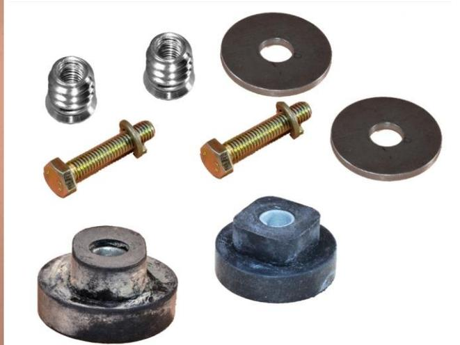
**IMPORTANTE:** Inserire l'antivibrante nella sede preposta sulle fusioni in alluminio! Esso consente di ammortizzare lo spostamento tra il radiatore acqua e l'intercooler dovuto alla differente dilatazione termica dei due radiatori. Cio' evita che l'intercooler possa strappare i tubi dell'acqua sotto il collettore.
