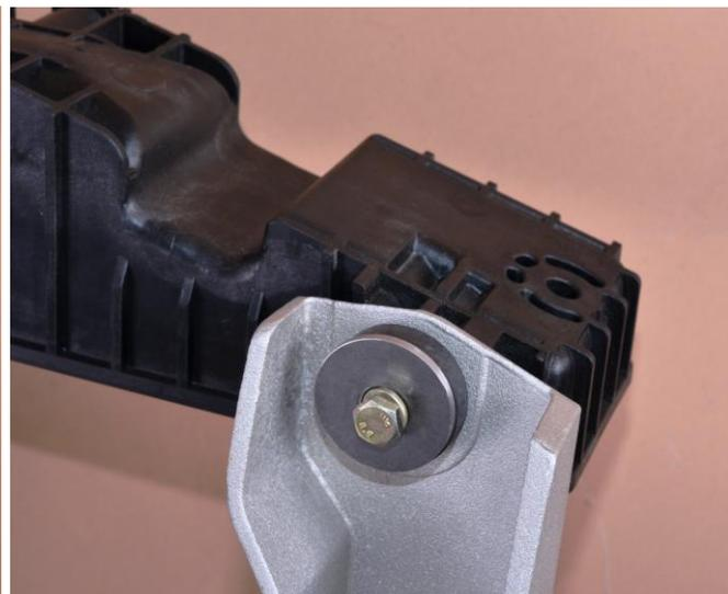
2. Inserire l'antivibrante nella sede sulle fusioni in alluminio (scegliendo destro e sinistro in funzione della forma) e in seguito serrare la vite
