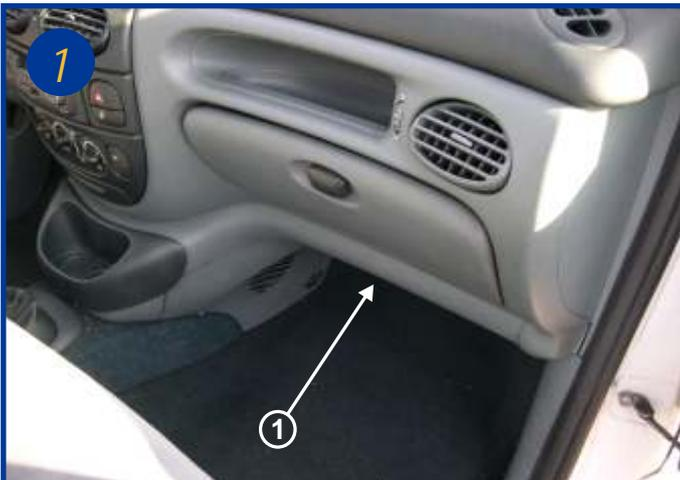
L'élément filtrant est placé dans l'habitacle du véhicule sous la boîte à gants coté passager. Ouvrir la portière coté passager et repérer l'emplacement d'une petite plaque plastique maintenue par 1 vis torx (voir flèche 1).
