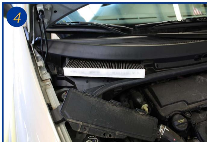
Sortir l'élément filtrant de son boîtier et le remplacer. Le remontage s'effectue dans l'ordre inverse du démontage.
