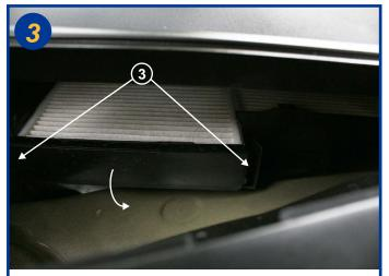
Ouvrir le logement en actionnant les fermoirs (3) Basculer le couvercle de fermeture (voir flèche).
