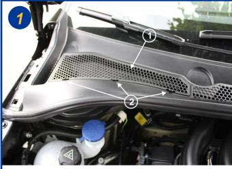
Les filtres d'habitacle sont situés sous le capot moteur, coté passager sous la baie de pare-brise (1). Ouvrir le capot moteur et pousser les 3 loquets de fermeture de la trappe de ventilation (2).
