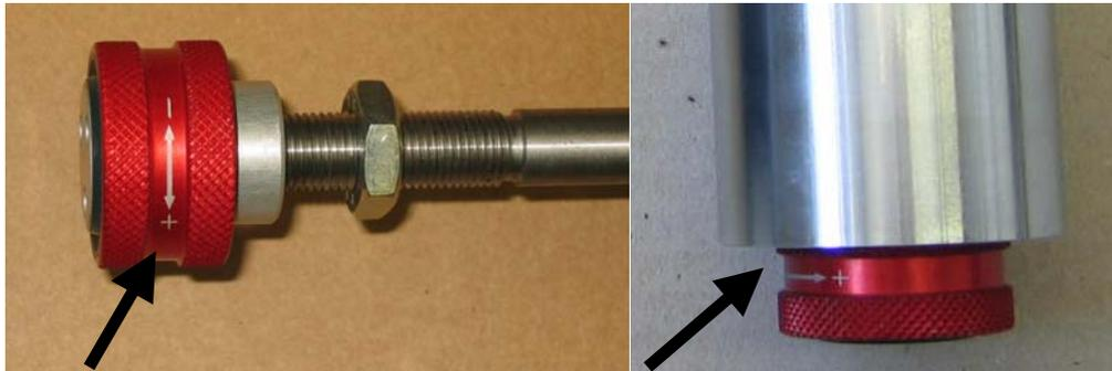
Die Dämpfungskraft kann OHNE Werkzeug per Hand im eingebauten Zustand verstellt werden!!! Beim Verstellen muss das Einrasten auf den verschiedenen Positionen mit einem „Klick“ deutlich spürbar sein.
