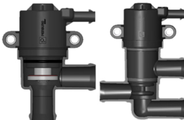
Schnittzeichnungen der Ventilvarianten
