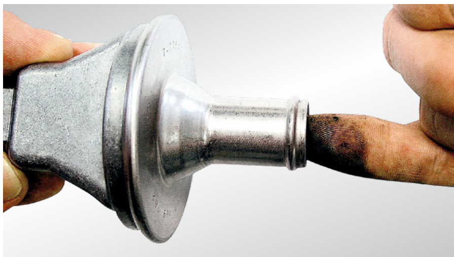
Fig. 32 Contrôle simple du clapet anti-retour
