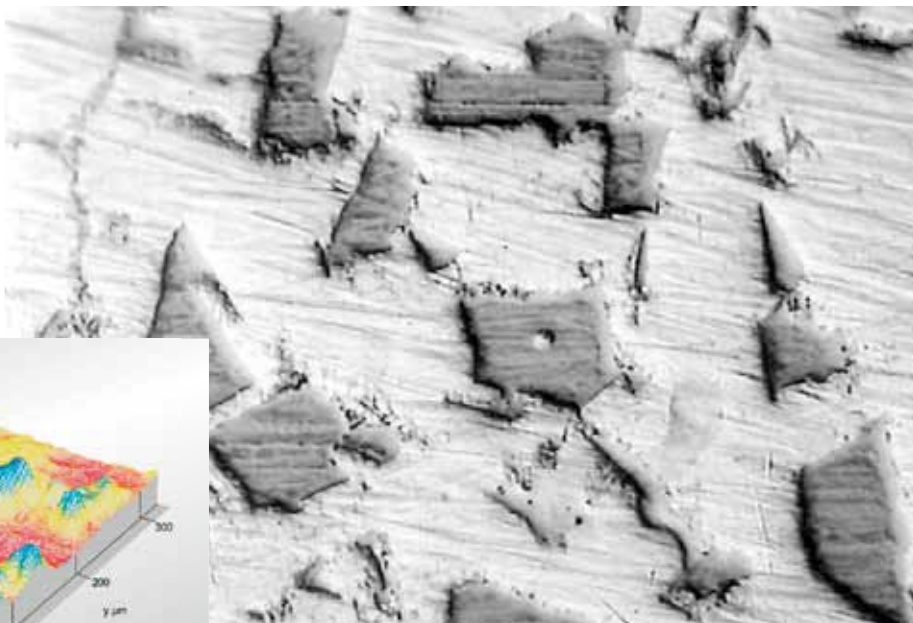
Изобр. 2 Alusil - рабочая поверхность цилиндра (150-кратное увеличение)
