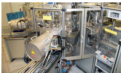
Processus PVD : revêtement au magnétron.
