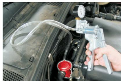
При помощи простых инструментов пневматические элементы конструкции легко можно проверить.
