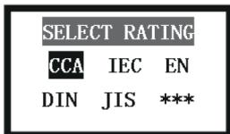
(6) Odpowiednio do etykiety umieszczonej na akumulatorze naciągnąć przycisk <▲><▼>, aby ustawić wartość znamionową. Patrz rysunek:
