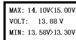
Die aktuelle Prüfspannung ist 13,88 V, die Standard-Maximalspannung ist 15,00 V (bei 24V-System ist die Standard-Maximalspannung 30,00 V), die geprüfte Maximalspannung ist 14,10 V.
