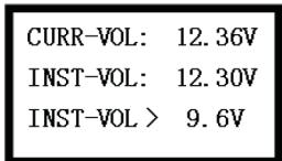
Jak widać na rysunku, aktualne napięcie kontrolne wynosi 12,36 V, napięcie standardowe 9,6 V (w instalacji 24 V napięcie standardowe wynosi 16 V), napięcie najwyższe to 12,30 V.
