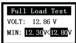
(5) Odczytać najniższą wartość. Jeśli jest ona wyższa niż 12,80 V (w instalacji 24 V napięcie wynosi ponad 25,60 V), instalacja pracuje normalnie.
