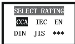
(6) Drücken Sie entsprechend dem Etikett auf der Batterie die Taste <▲><▼>, um den Nennwert einzustellen. Siehe Bild:
