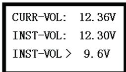
Wie im Bild zu sehen ist, beträgt die aktuelle Prüfspannung 12,36 V, die Standardspannung 9,6 V (bei einem 24-V-System beträgt die Standardspannung 16 V), die niedrigste Spannung ist 12,30 V.
