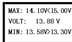
Aktualne napięcie kontrolne wynosi 13,88 V, standardowe napięcie maksymalne wynosi 15,00 V (w instalacji 24 V standardowe napięcie maksymalne wynosi 30,00 V), skontrolowane napięcie maksymalne wynosi 14,10 V. Inna wartość pokazuje, że aktualne napięcie kontrolne wynosi 13,88 V, standardowe napięcie minimalne wynosi 13,30 V (w instalacji 24 V standardowe napięcie minimalne wynosi 26,60 V), skontrolowane napięcie minimalne wynosi 13,58 V.
