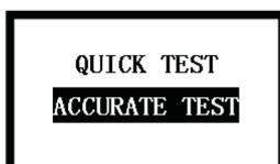
(5) Drücken Sie die <▲><▼> Taste, um den Teststandard entsprechend dem Standard des Akkus auszuwählen. Wenn es sich um den JIS-Standard handelt, müssen Sie den CCA-Wert anhand der Vergleichstabelle überprüfen. Wählen Sie dann CCA (SAE) als Teststandard und drücken Sie weiter <ENTER>. Siehe Bild:
