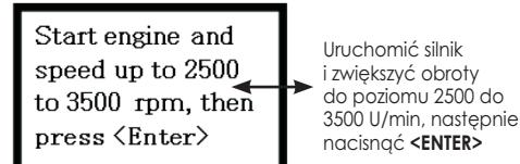
(4) Po wykonaniu czynności opisanych w kroku (3) naciśnij <ENTER>, aby wyświetlić ekran testu układu ładowania, jak pokazano na rysunku poniżej:
