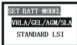
(4) Drücken Sie entsprechend der Beschriftung der Batterie die Taste <▲><▼>, um Schnelltest oder genauen Test auszuwählen. Das untere Bild zeigt die Auswahl des genauen Tests, drücken Sie <▲><▼> weiter. Siehe Bild:
