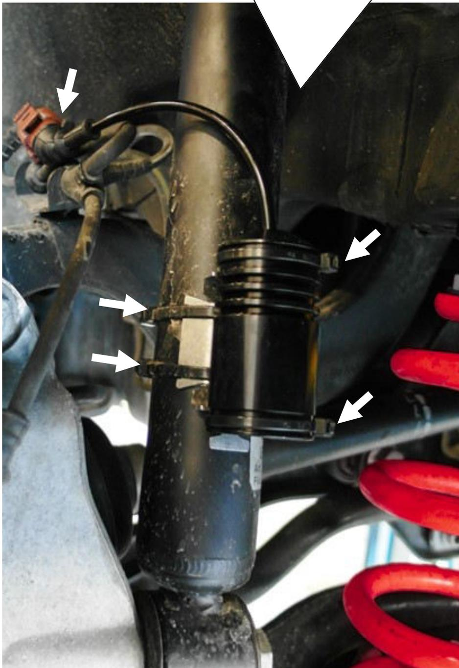
Klebeband auf den montierten Halter ankleben. **WICHTIG: Klebefläche muss Staub- und Fettfrei sein.**
